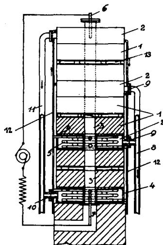
Anzahl der vorhandenen Luftzufuhr- und Gasableitungsöffnungen die Geschwindigkeit der den Ofen passierenden Luft verringert wird, und diese Geschwindigkeitsverringerung kann so weit getrieben werden, daß ein Abreißen der Flamme durch den Luftstrom unter keinen Umständen mehr eintreten kann. (D. R. P. 231 584. Kl. 12h. Vom 23./5. 1908 ab.) *rf.* [R. 747.]
