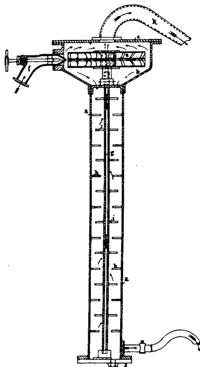
hitzten Stoffe unter Druck gegen ein in einem oben kastenartig erweiterten Rohr befindliches Turbinenrad o. dgl. gespritzt und die in dem Rohr herabfließende Masse durch von der Turbine angetriebene Rührer durchgearbeitet wird, so daß kontinuierlich ein entwässertes Produkt abfließt.
